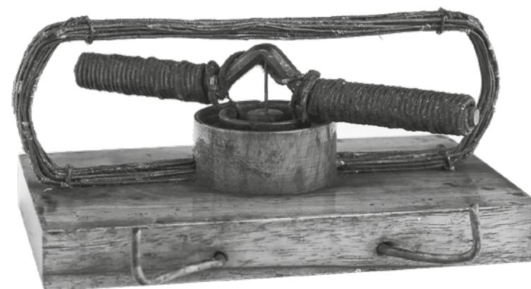
Jedlik Ányos szerkesztette ős-villanymotor
